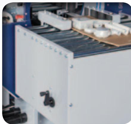
Guide laterali motorizzate regolabili manualmente in larghezza Motorized sides guides width adjustable
