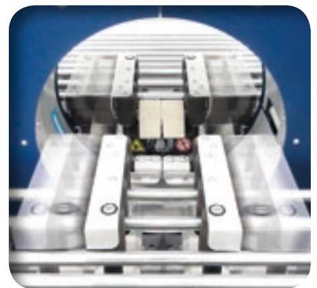
Guide a rulli motorizzati e auto-centranti opzionali Optional motorized roller guides and self-centering
